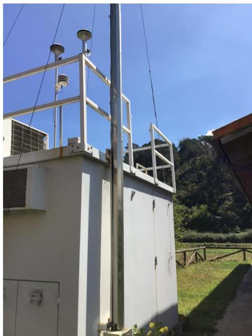
Figura 90. Toma de muestra de gases y partículas y estación meteorológica de la estación Salinas
