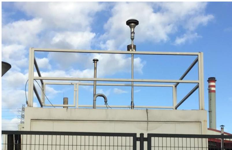
Figura 108. Toma de muestra de gases y partículas y estación meteorológica de la estación Matadero. El punto de entrada de muestra está situado cerca de posibles fuentes de emisión, por lo que puede producir la entrada directa de emisiones sin mezclar con el aire ambiente. Esto es, en este caso las medidas corresponden directamente con los gases y partículas emitidos de manera continuada en la Avenida de la Industria y el Puerto (camiones aparcados en el arcén de la Avenida de la Industria).
