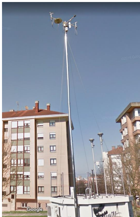
Figura 118. Toma de muestra de gases y partículas y estación meteorológica de la estación Montevil
