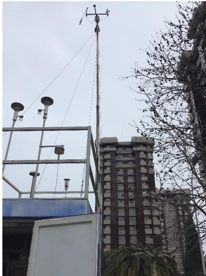
Figura 37. Toma de muestra de gases y partículas y estación meteorológica de la estación Constitución
