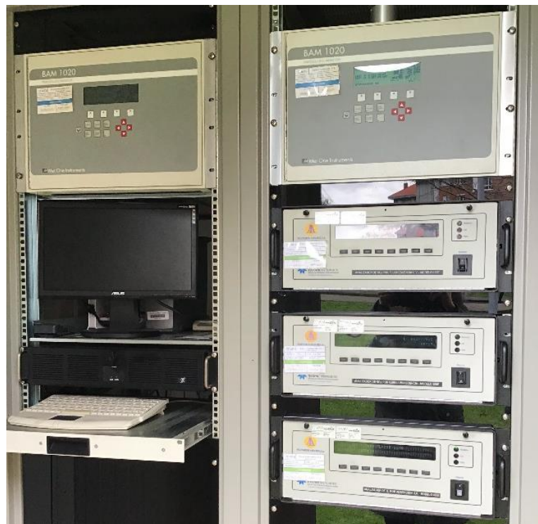
Figura 109. Equipos de medida de la calidad del Aire de la estación Montevil
